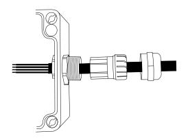
Para instalar, se faz necessário abrir a chave de vibração VIB-100 com cuidado, inserir o cabo com as pontas dos fios devidamente decapados (aproximadamente 0,4mm) e fixálos no borne como indicado<sup>1</sup>:
