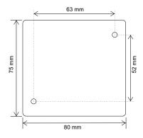
Obs: 1-A fixação é feita por parafusos inseridos pela parte interna da VIB-100. 2-Vista pela parte inferior (base).
